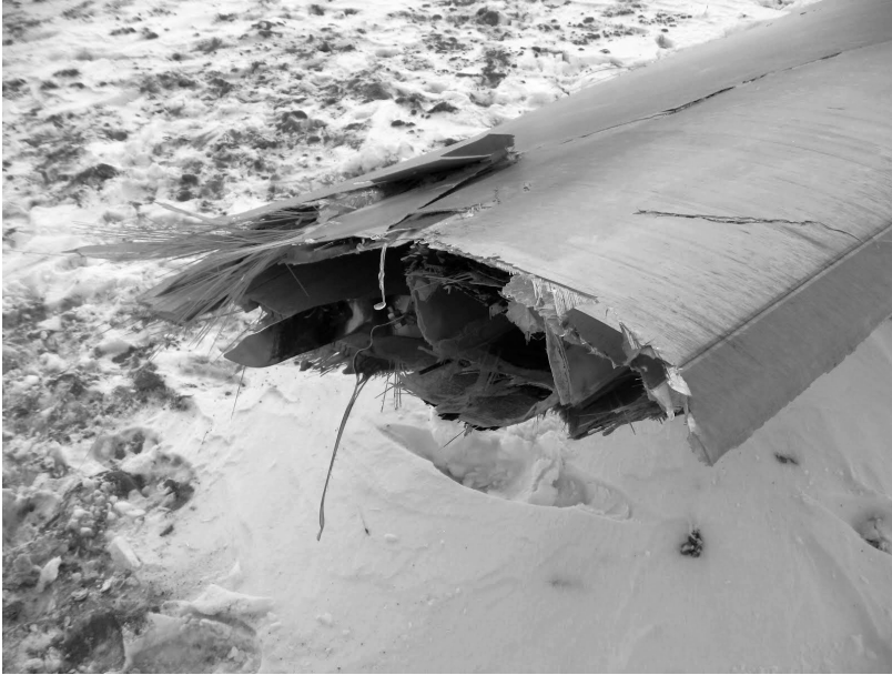
Joonis 1. Tuulegeneraatori laba ehitus.
