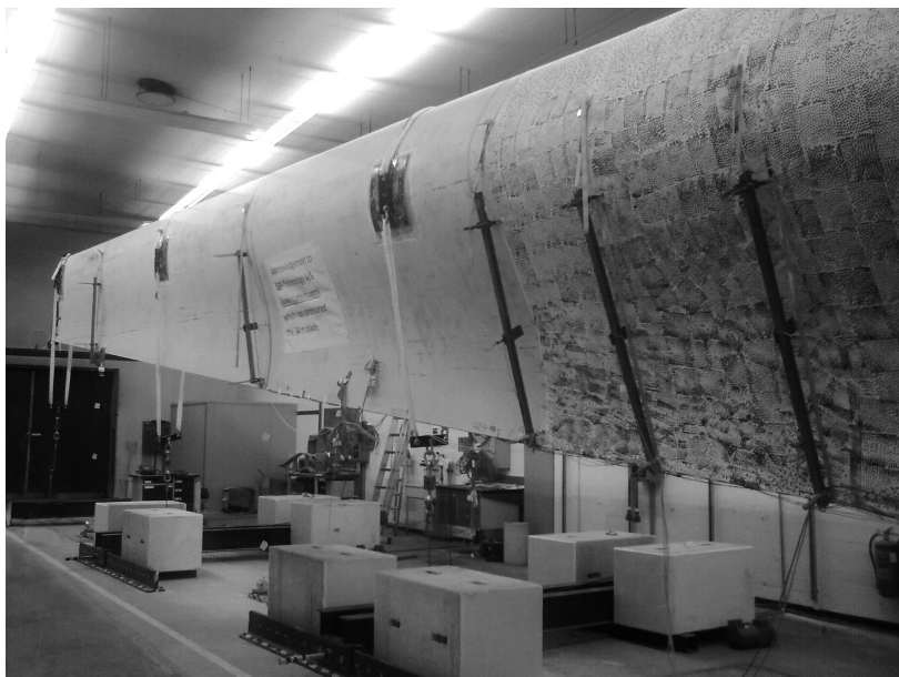
Joonis 6. Tuulegeneraatori koormatud laba.
